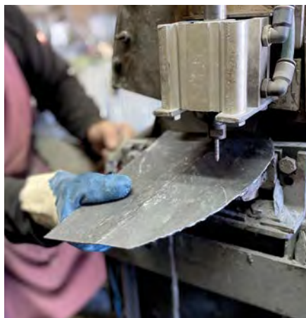
Traditionelle Frei-Hand-Zurichtung in der Altdeutschen Deckung
