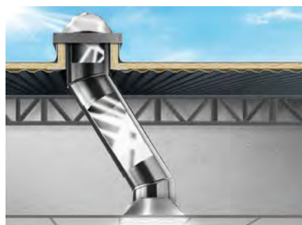
Das Solatube Prinzip – Einfangen, Weiterleiten und Ausleuchten für maximale Tageslichtversorgung
